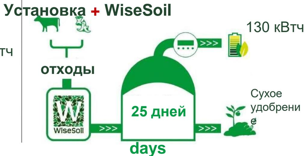
Модуль WiseSoil устанавливается на действующую БГУ и подготавливает сырьё перед подачей в биогазовый реактор
